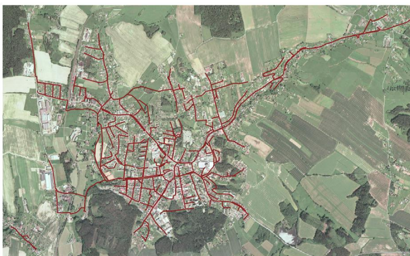
Obr. 14: Kanalizační síť v Červeném Kostelci
